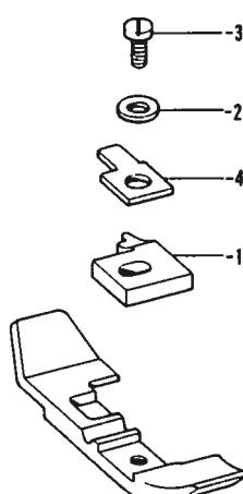
E. 押工関係 / Presser foot mechanism / Stoffdrückerfuß /
